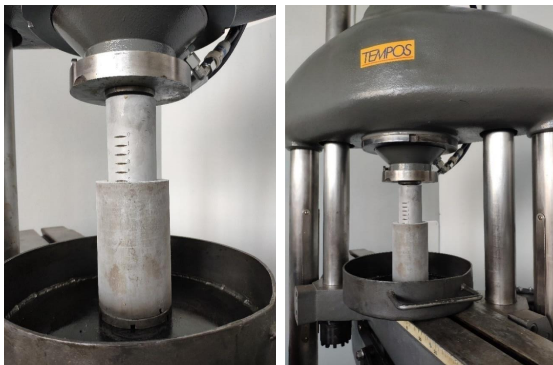
Obr. 20 Lisování při teplotě -40 °C
