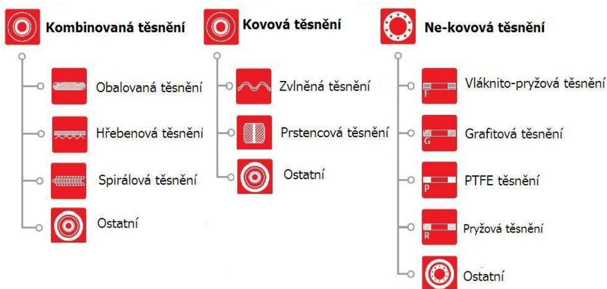
Obr. 1-1-Rozdělení statických těsnění[12]
