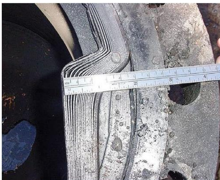
Obr. 5-1 Příklad zborceného spirálového těsnění[3]
