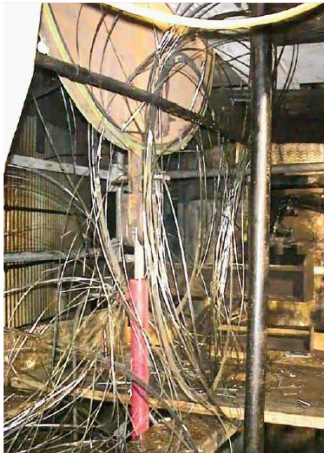
Obr. 5-2 Příklad rozsypaného spirálového těsnění[3]
