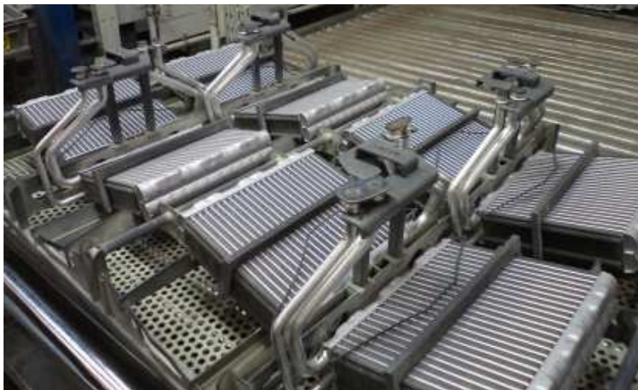
Obrázek 10: První rám při výstupu z pece
