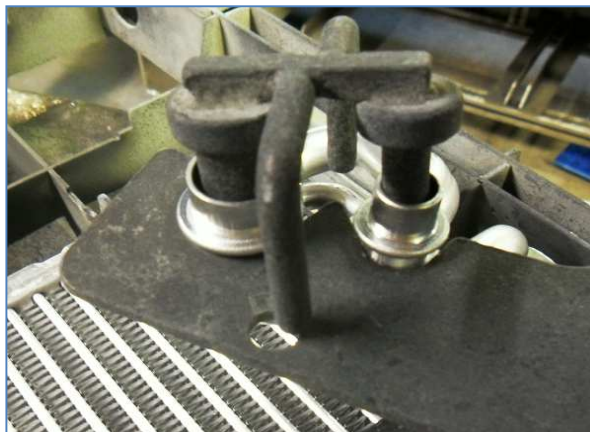
Obrázek 34: Násilná montáž staré letovací krytky
