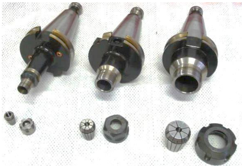
Obr.1.4 Příklad upnutí frézy s válcovou stopkou pomocí upínací hlavice s kleštinou [9].
