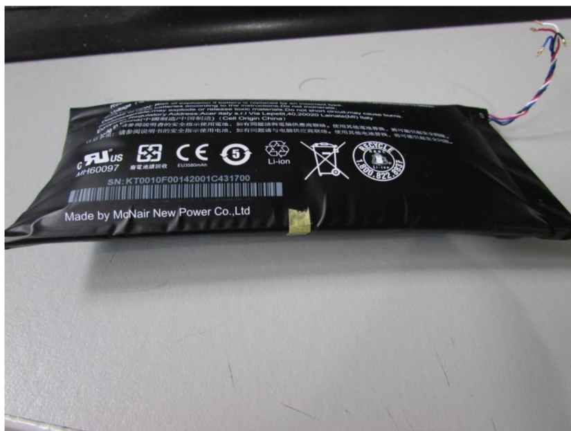
Obr. 7 Li-ion akumulátor – nafouklý, došlo k poruše řídicího obvodu
