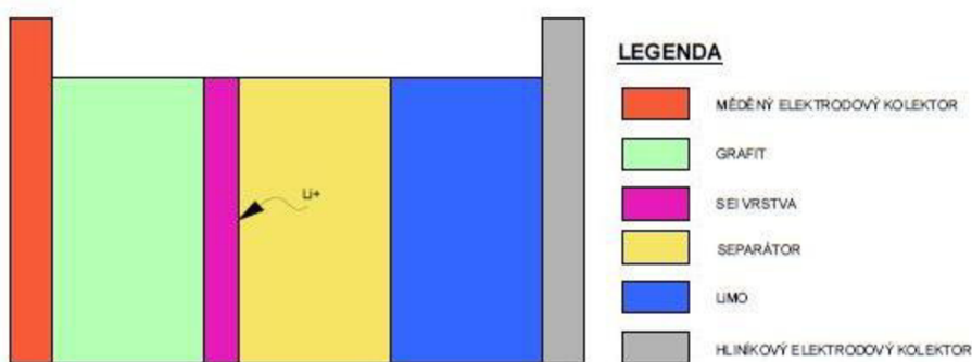
Obr. 10 SEI vrstva u anody na bázi grafitu
