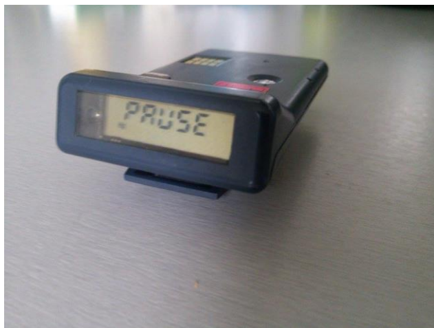
Obr. 3: Dozimetr v režimu „PAUSE“
