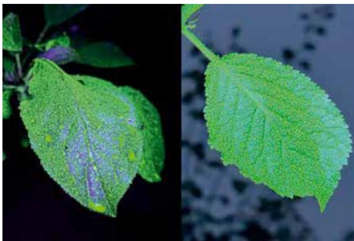
Obrázek 35: Rozložení barviva na listové stěně s aktivním a neaktivním elektrostatickým systémem (KUHN CENTER CZ, 2023)
