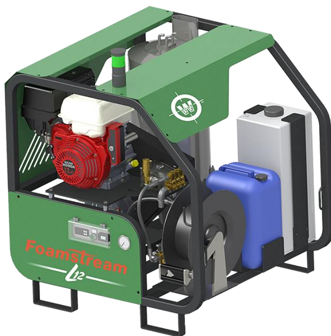
Obrázek 5: Regulační mechanismus s použitím horké vody a pěny - Foamstream L12 (Weedingtech, 2024)
