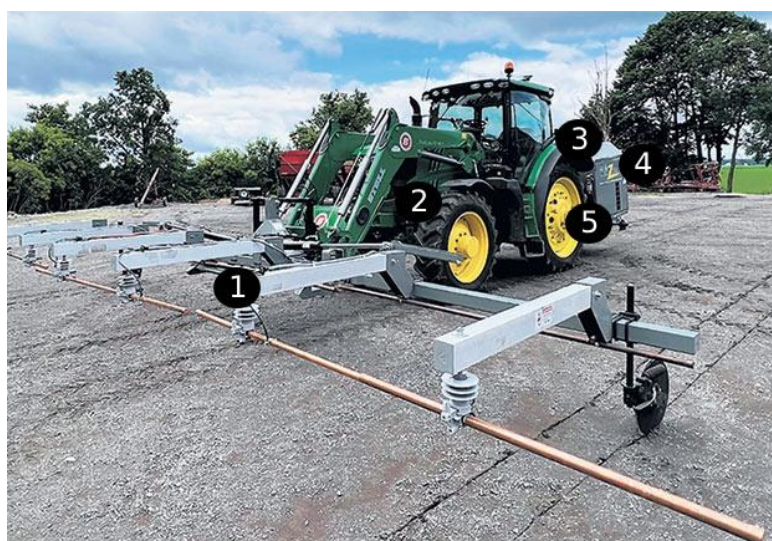
Obrázek 14: Schéma zařízení na principu jiskrového výboje - The Weed Zapper (Laterre, 2022) - upraveno
