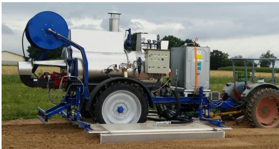
Obrázek 8: Regulační mechanismus MSDA 600 s napařovacími jednotkami (Internet, 2016)
