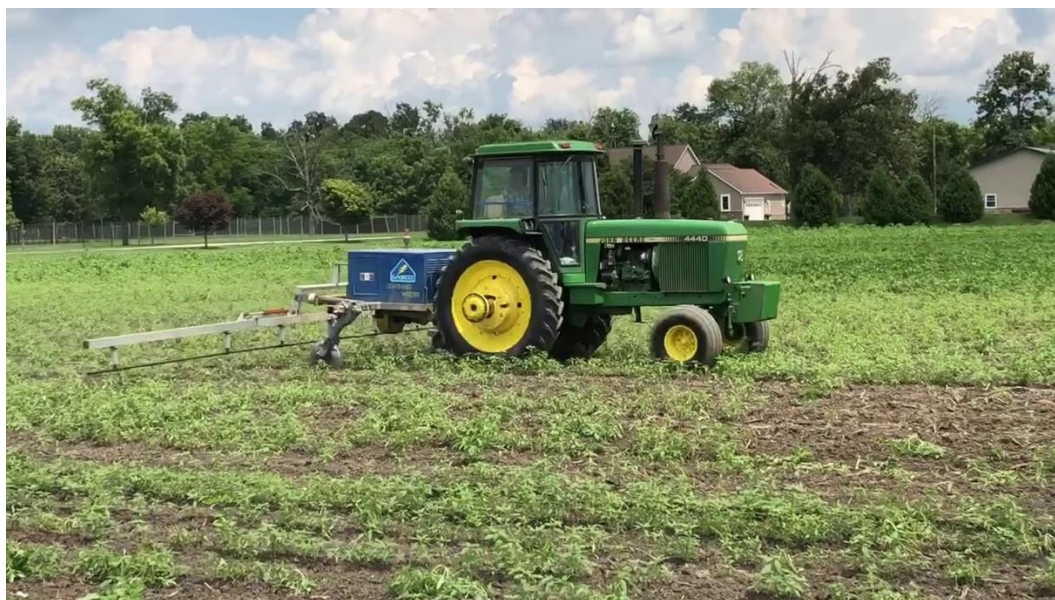
Obrázek 15: Zařízení pracující na principu jiskrového výboje - Lightning Weeder (Slaven et al., 2023)
