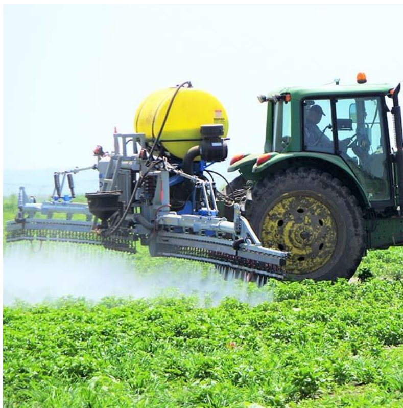
Obrázek 30: Elektrostatický postřikovač MaxCharge modelové řady 450RC (Electrostatic Spraying Systems, Inc., 2024)
