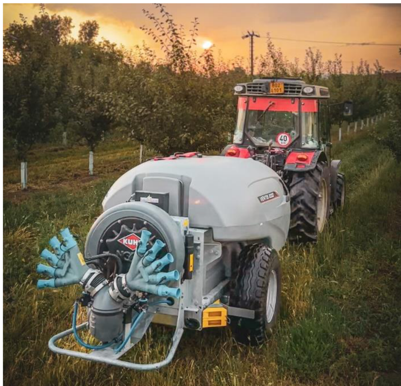
Obrázek 26: - Elektrostatický rosič Ventis s Venturiho trubicemi (KUHN CENTER CZ, 2023)
