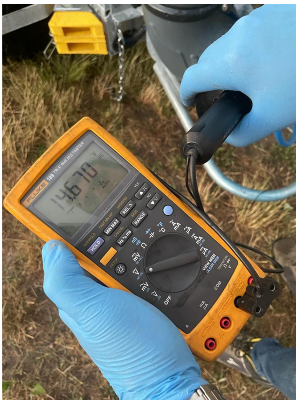
Obrázek 34: Změření napětí na ES systému pomocí multimetru (KUHN CENTER CZ, 2023)
