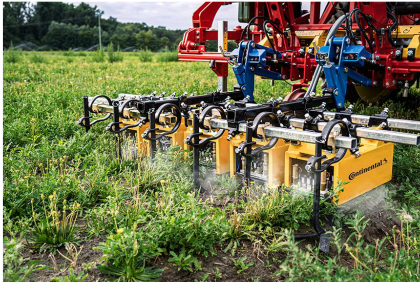
Obrázek 3: Systém kontroly plevelu horkou vodou - Continental AG (Hattum, 2023)
