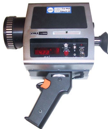
Obrázek 3.5 Jasoměr LMT L1009 [12]
