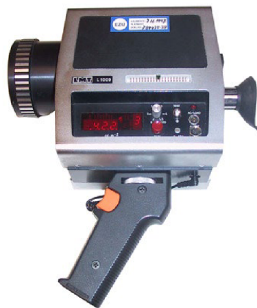
Obrázek 3.5 Jasoměr LMT L1009 [12]
