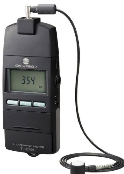
Obrázek 3.3 Luxmetr Minolta T10 [8]
