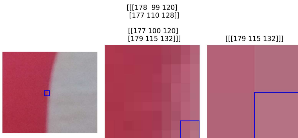
Obr. 57: Číselná reprezentace 8bitového digitálního obrazu
