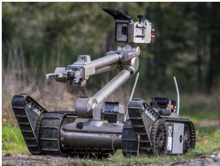
Obr. 2: PackBot – mobilní robot používaný především pro likvidaci bomb [6]
