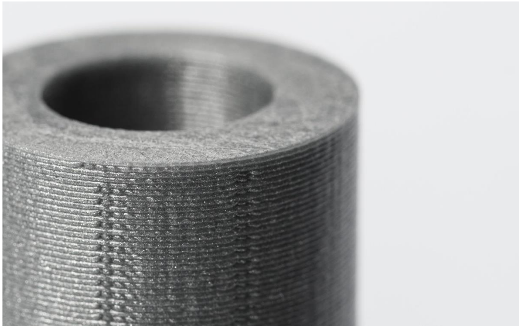
Obr. 1 Detail modelu tištěného FFF metodou. [6]
