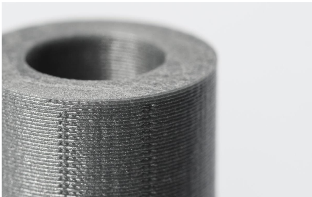
Obr. 1 Detail modelu tištěného FFF metodou. [6]
