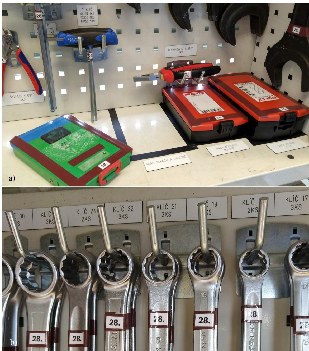
Obrázek 46: a) vnitřní prostor vzorové závěsné skříně s uplatněním nově navržených standardů 5S, b) detail nově konceptu značení náradí a nástrojů včetně plastových štítků pro označení pozic ve skříně, foto autor.
