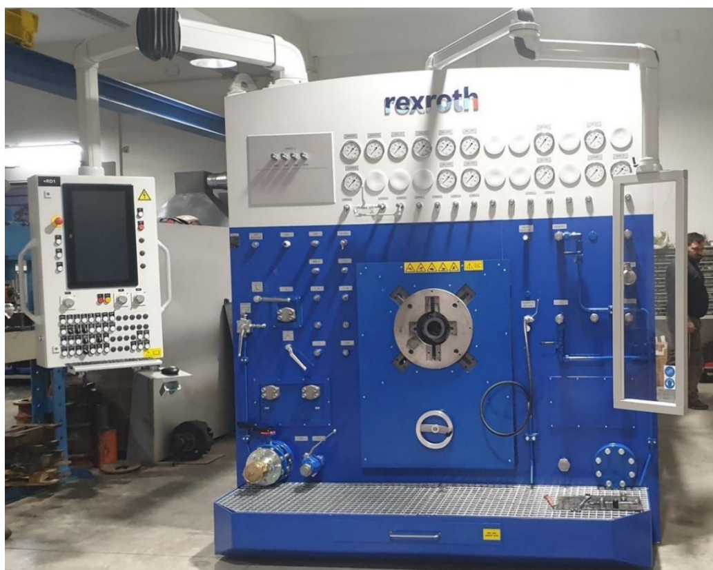
Obrázek 5: Stolice pro zkoušky a nastavení hydraulických čerpadel [12].
