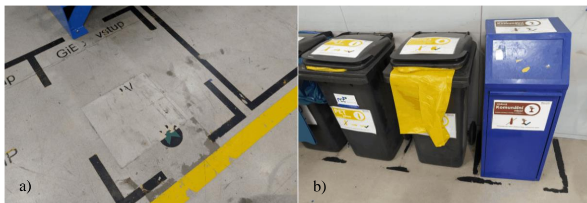
Obrázek 28: a) poškozené podlahové značení (zde prostor pro paletu), b) značení míst pro odpadkové koše, foto autor.
