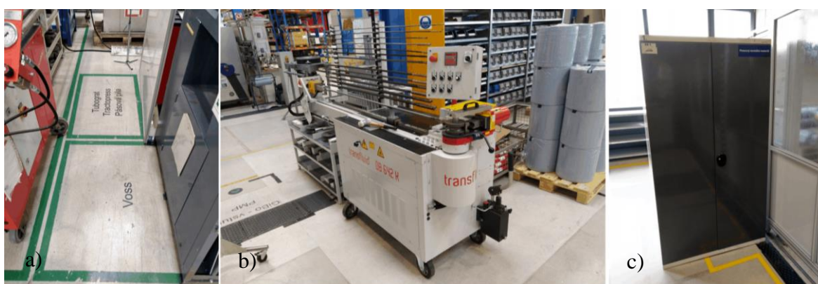
Obrázek 27: a) prázdné pozice někdejšího umístění strojů, b) nové umístění stroje bez aplikovaného podlahového značení, c) změna polohy skříně nerespektující značení, foto autor.
