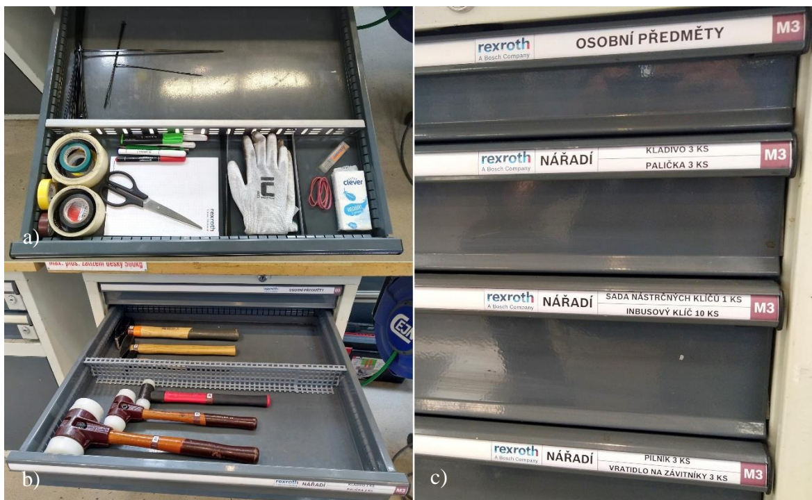
Obrázek 47: a) zásuvka pro uložení osobních předmětů zaměstnanců, b) nový standard 5S v zásuvce s nářadím bez užití molitanových vložek, c) detail na nově navržený standard značení zásuvek, foto autor.
