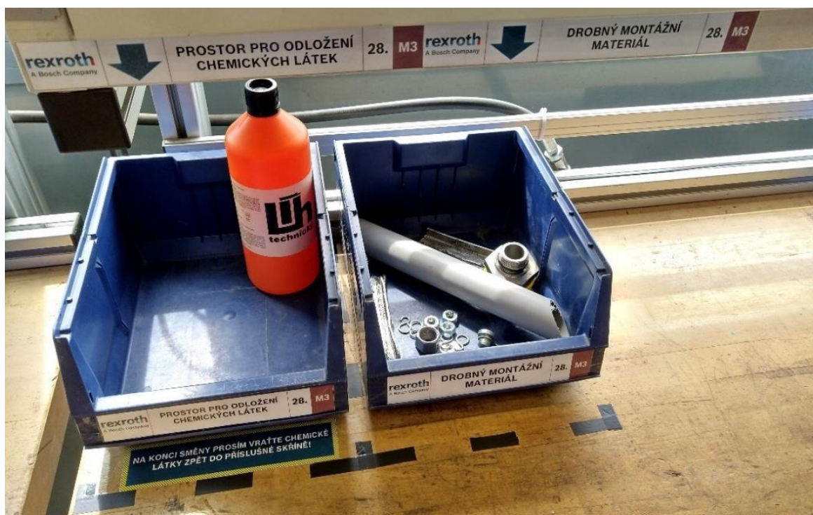
Obrázek 42: Prototypová realizace nového standardu 5S na pracovní desce dílenského stolu, foto autor.
