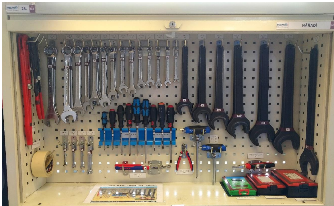
Obrázek 45: Výsledný stav vzorové závěsné skříň na pracovním místě č. 28 po zavedení nových standardů 5S, foto autor.
