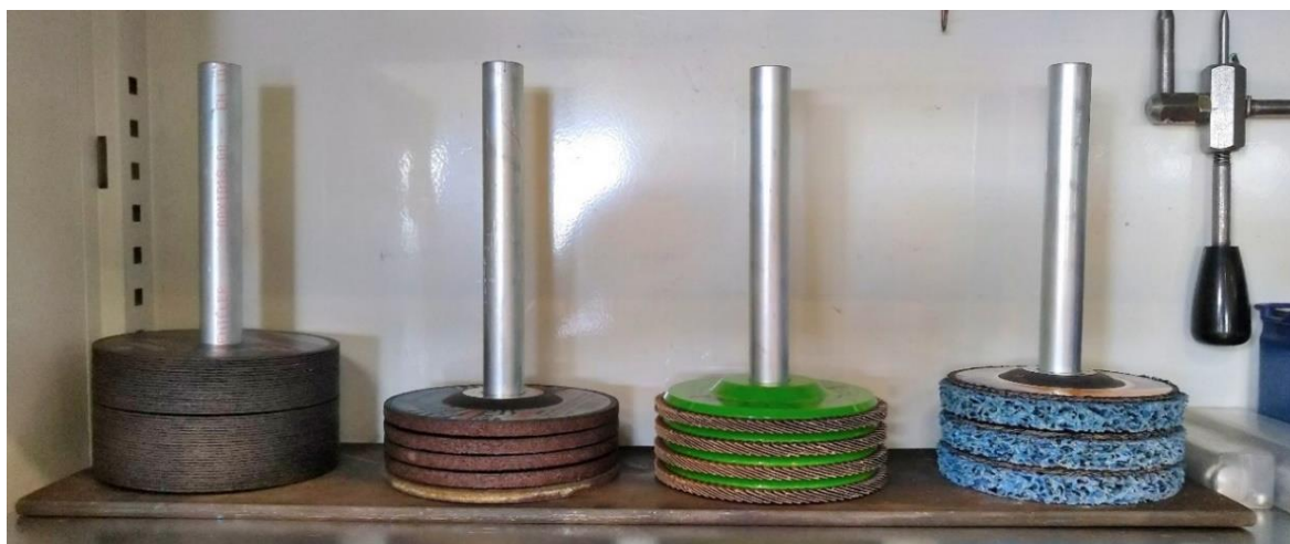
Obrázek 50: Prototypová realizace nově navrženého standardu pro uspořádání řezných a brousících kotoučů, foto autor.
