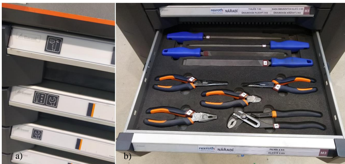
Obrázek 48: a) původní nejednoznačné označení zásuvek pomocí piktoqramů, b) nově navržený standard 5S pro zásuvky mobilních vozíků i pracovních stolů s využitím molitanových vložek, foto autor.
