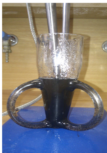
Obr. č. 15: Speciální nádobka na dispergaci uhlíkových částic pomocí ultrazvuku
