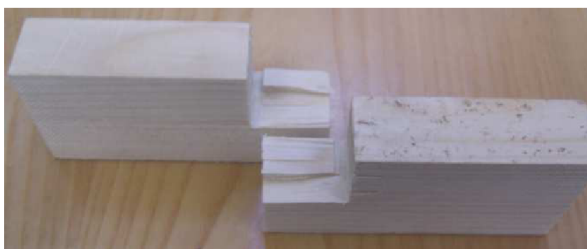
Obr. č. 21: Příklad kohezního porušení, které bylo stanoveno na 70 %.
