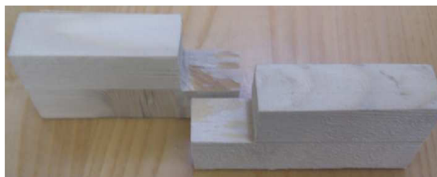
Obr. č. 22: Příklad kohezního porušení, které bylo stanoveno na 20 %, je zde viditelné pouze pár odtržených dřevních vláken
