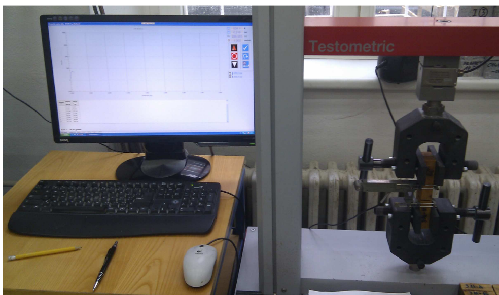
Obr. č. 19: Tahový lis Testometric s čelistmi pro uchycení vzorku se zaznamenávacím zařízením pro vyhodnocení výsledků a tenzometrem.
