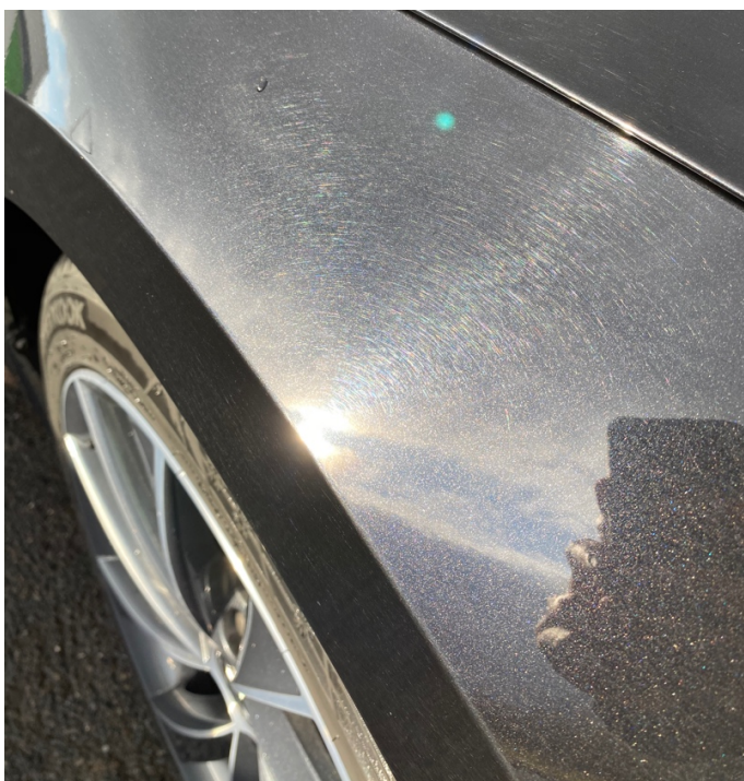
Obr. č. 10: Hologramy na laku vozidla způsobené kontaktními automatickými mycími linkami
