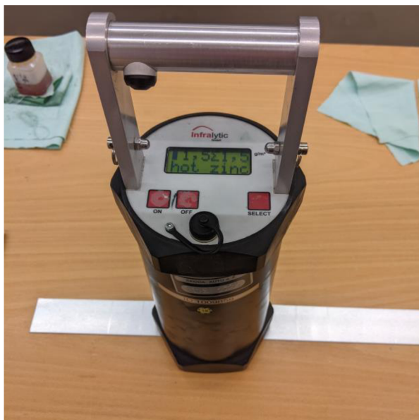
Obr. 28 Měření množství maziva na testovaném vzorku
