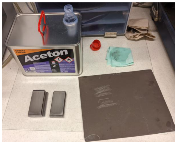
Obr. 27 Očištění testovacích čelistí
