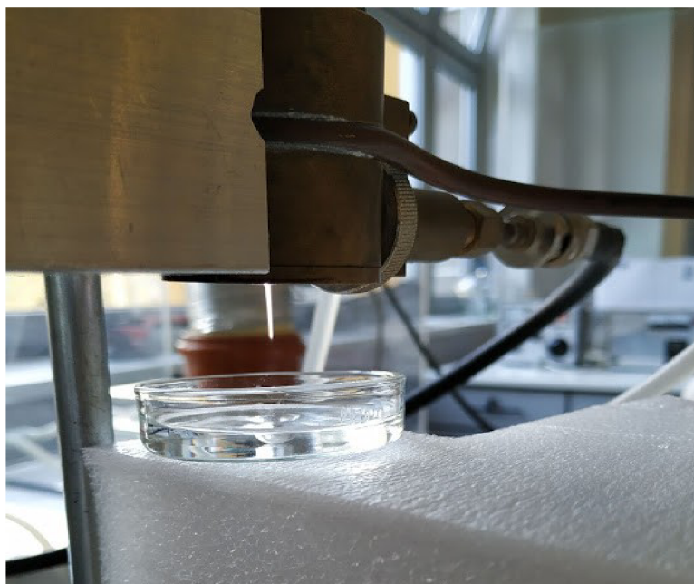
Obrázek 7 - Působení plazmatu z mikrovlnné trysky na hladinu kapaliny
