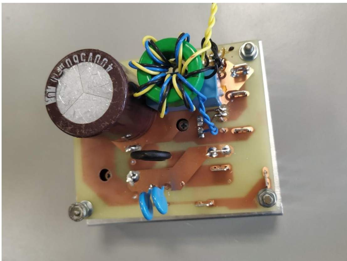
Obrázek 3.3 Fotka vyrobené a osazené silové desky
