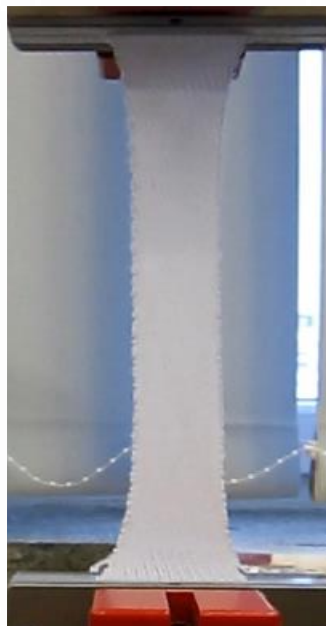
Obr. 23: Namáhání materiálu v diagonálním směru
