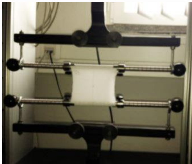
Obr. 10: Měření komprese pomocí trhacího přístroje [27]
