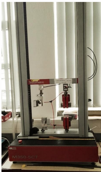
Obr. 32: Trhací přístroj M350-C5
