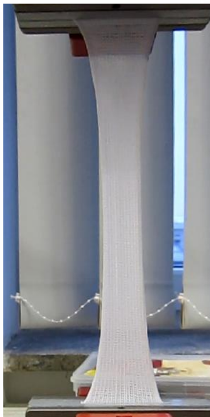
Obr. 19: Namáhání materiálu v podélném směru
