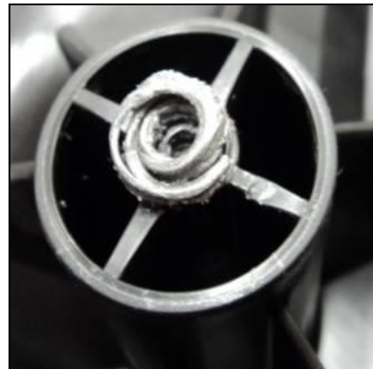
Obr. 3.43 Test s originálním protikusem[18] 3.44 Ukázka strhnutého závitu RPS bodu [18]
