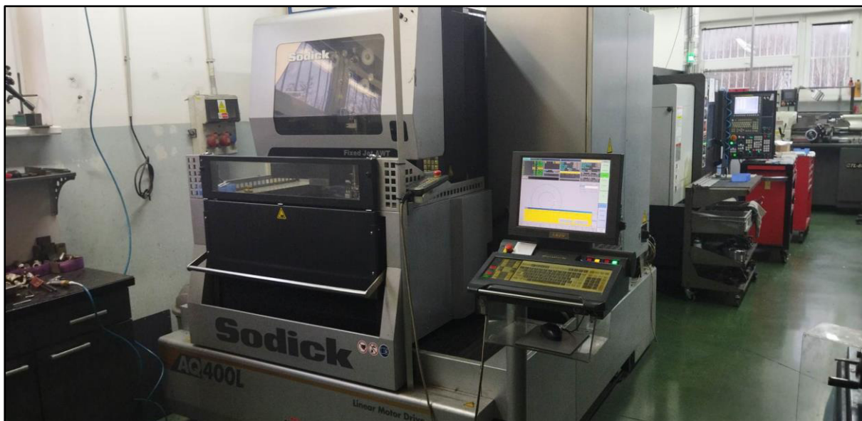
Obr. 1.0 Umístěná drátová řezačka Sodick ve strojovém parku malé střední firmy.
