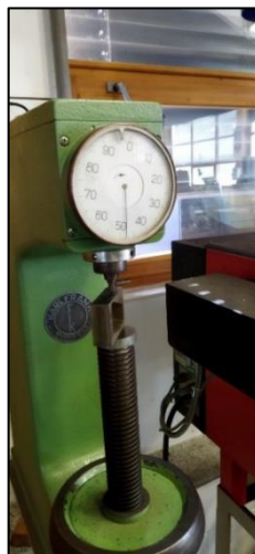
Obr. 4.23 Měření tvrdosti na přístroji Rockwell 150 Analog.
