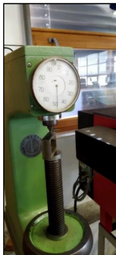
Obr. 4.23 Měření tvrdosti na přístroji Rockwell 150 Analog.
