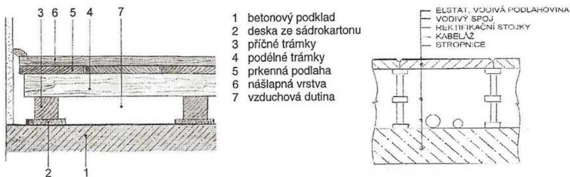
Obr. 4-27 Dvojité podlahy roštové a na bodových podpěrách (3) (14)
