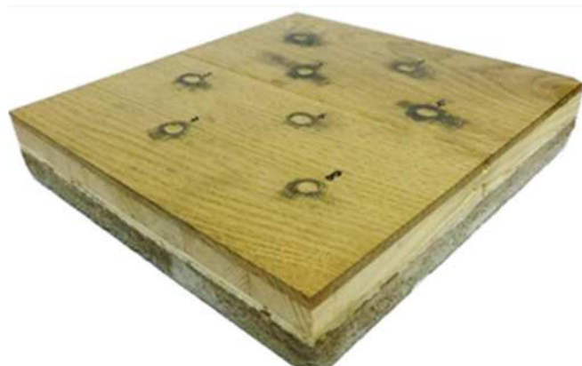
Obr. 9-10 Zkušební vzorek s vtisky
