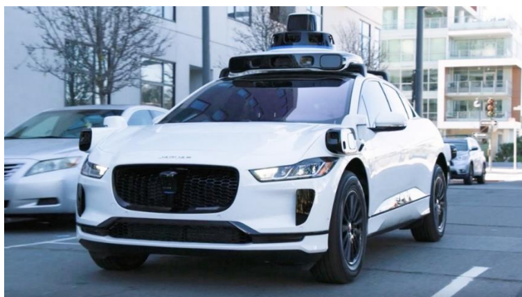
Obrázek 6 - Automobil využívající technologii autonomního řízení Waymo Driver
