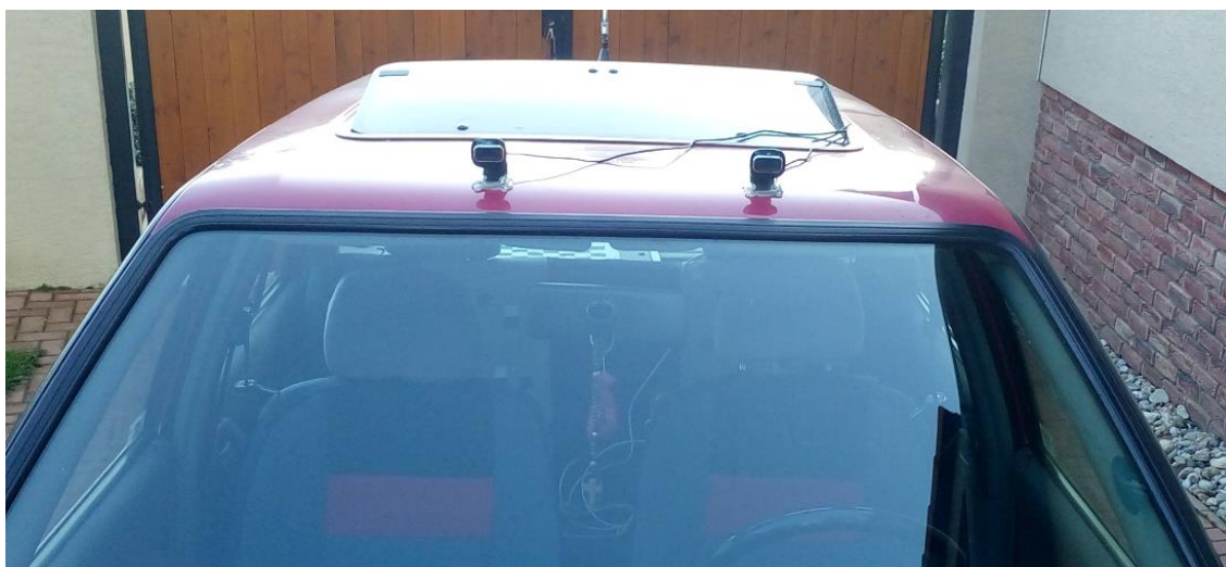
Obr. 4-12 Kamery na střeše vozidla
