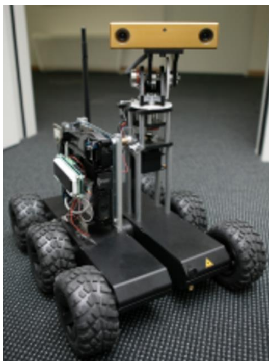
Obr. 3-9 Stereo kamera Bumblebee 2 použitá s mobilním robotem [36]
