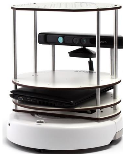
Obr. 3-4 TurtleBot na podvozku iRobot, osazen zařízením Kinect [32]
