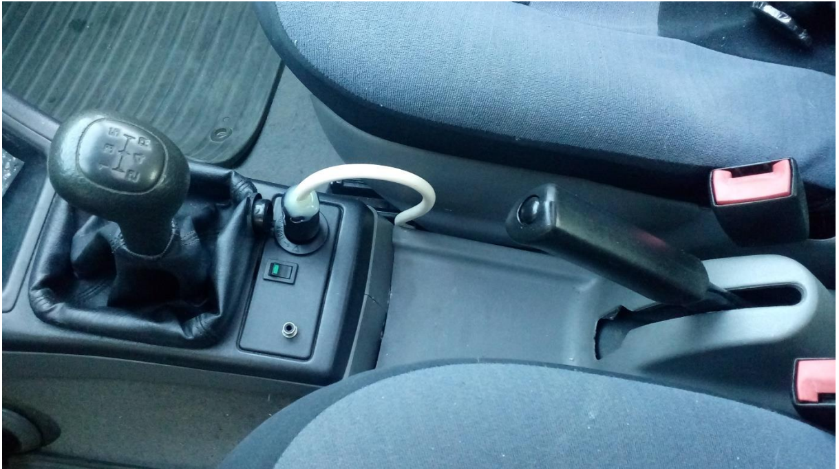
Obr. 4-17 Zásuvka zapalovače pro napájení experimentální soustavy
