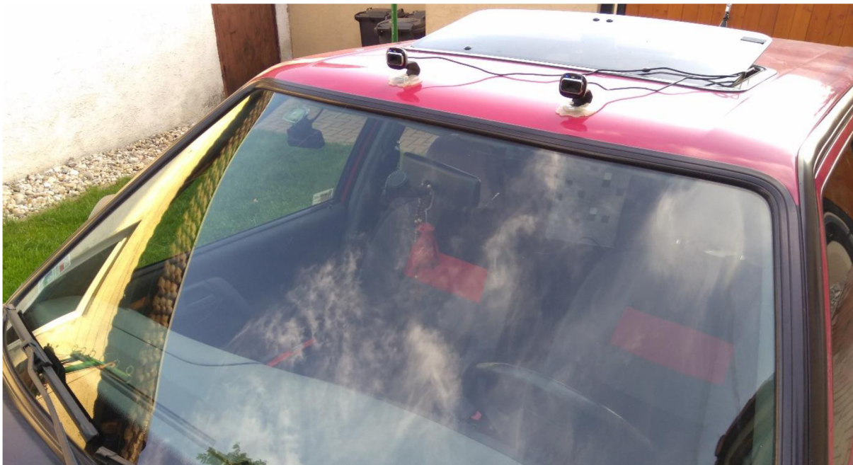
Obr. 4-13 Kamery na střeše vozidla + třetí kamera na čelním skle zevnitř
