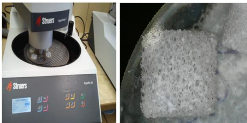
Obr. 22 Bruska Struers TegraForce-5 a ukázka výsledného keramografického výbrusu.
