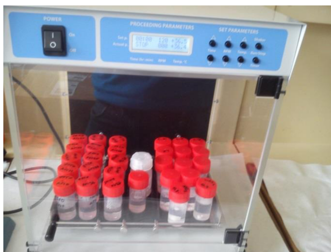
Obr. 25 Inkubátor, kde probíhal test SBF.
