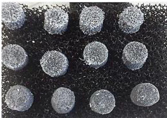
Obr. 20 Vzorky 1. koncentrace po zaschnutí. Nahoře jsou vzorky o velikosti pórů 60 ppi, uprostřed vzorky 75 ppi, dole vzorky 90 ppi. Zvětšení – 1,2 krát.
