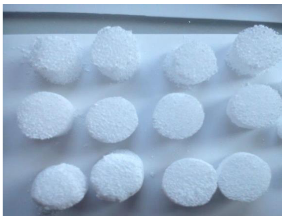
Obr. 21 Vzorky 1. koncentrace po slinutí. Nahoře jsou vyobrazeny vzorky o velikosti pórů 60 ppi, uprostřed 75 ppi a dole 60 ppi. Zvětšení – 1,7 krát.
