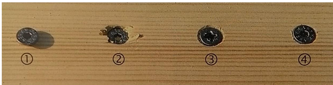
Obrázek 9: Způsoby zapuštění vrutů do dřevěného materiálu (GABRIEL, 2011)
