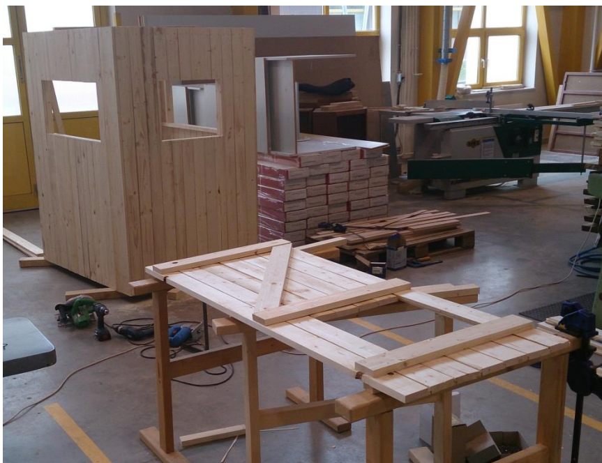
Obrázek 20: Dveře připravené pro vložení do kratší stěny kazatelny (autor)
