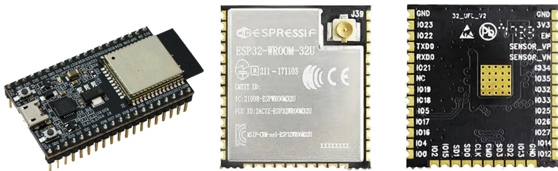
(a) čip ESP32 integrovaný na vývojovém kitu ESP32 Devkit C 7
