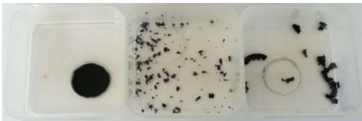
Obr. 19 Vzorky PEDOT:DBSA v deionizované vodě zahříváné na 140 °C po 21 dnech delaminačního testu. Zleva: vzorek PEDOT:DBSA/GOPS s tenkou vrstvou stále přilehlou ke skleněnému substrátu; delaminovaný a rozpadlý vzorek PEDOT:DBSA/DVS; delaminovaný a rozpadlý vzorek PEDOT:DBSA bez síťovacího činidla
