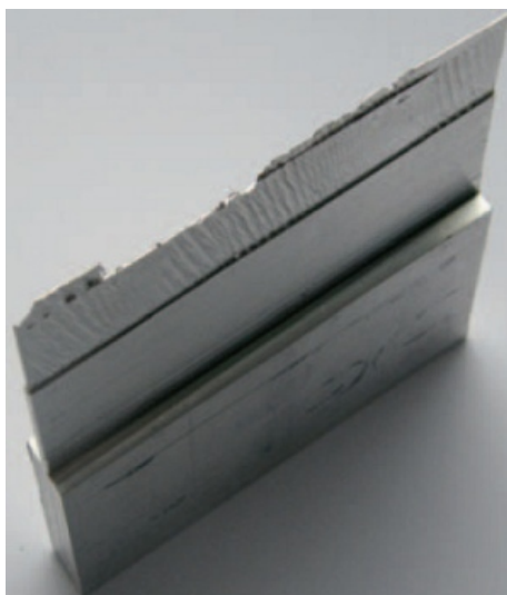
Obr. 22 Destrukce tenkostěnné součástky při obrábění [30].
