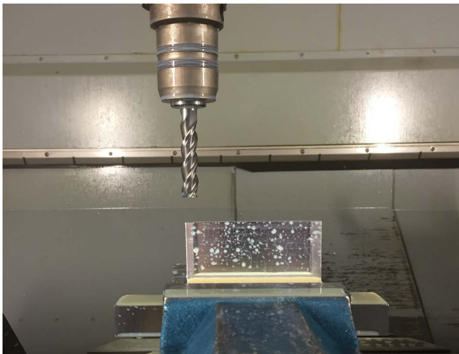
Obr. 56 Prostor stroje při frézování tenkostěnné součástky.
