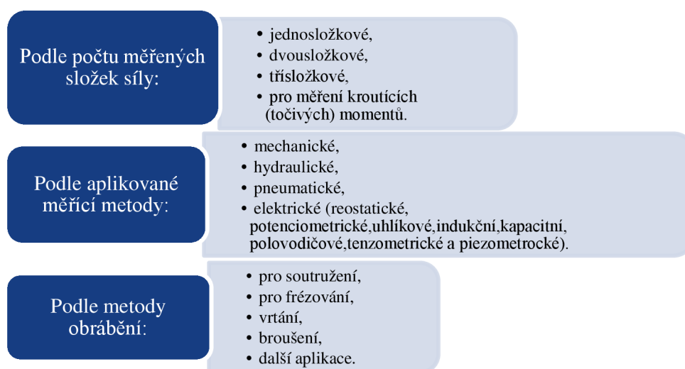
Obr. 7 Základní rozdělení dynamometrů [4].
