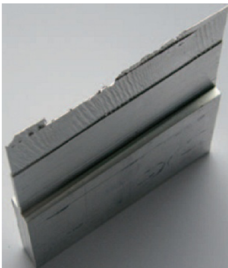
Obr. 22 Destrukce tenkostěnné součástky při obrábění [30].
