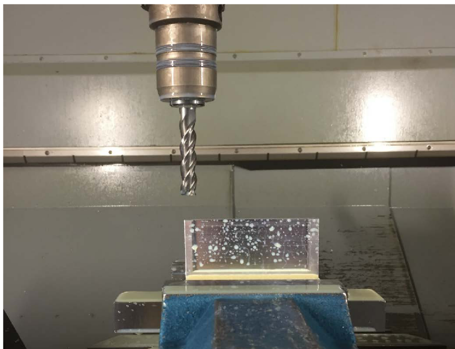
Obr. 56 Prostor stroje při frézování tenkostěnné součástky.
