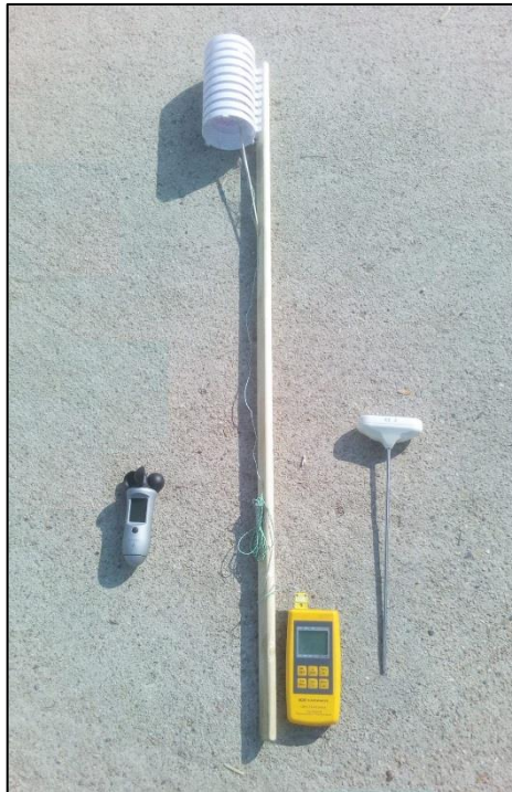
Obr. 7 Měřicí přístroje, zleva anemometr, teploměr s čidlem v radiačním krytu umístěném na tyči, ponorný teploměr; vlastní fotografie (datum pořízení: 4. 8. 2018)
