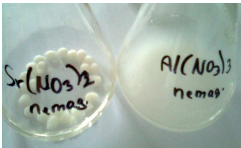
Obrázek 15: Kuličky po 24 hodinách mechanického zatížení (nemagnetická verze).
