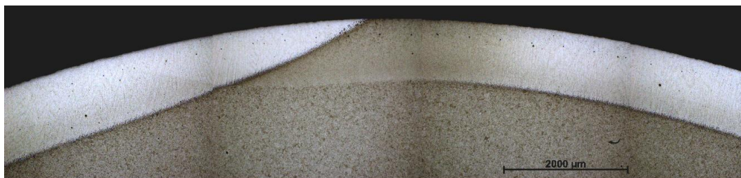
Obrázek 46: Překryv kalených stop při konvenčním rotačním kalení
