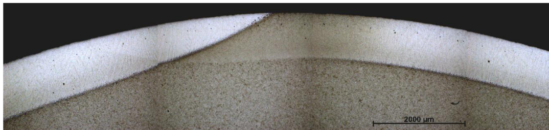
Obrázek 46: Překryv kalených stop při konvenčním rotačním kalení
