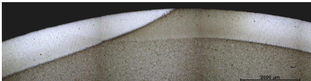
Obrázek 56: Měkké místo na obvodu součásti vzniklé kvůli opětovnému zahřátí již zakalené struktury.
