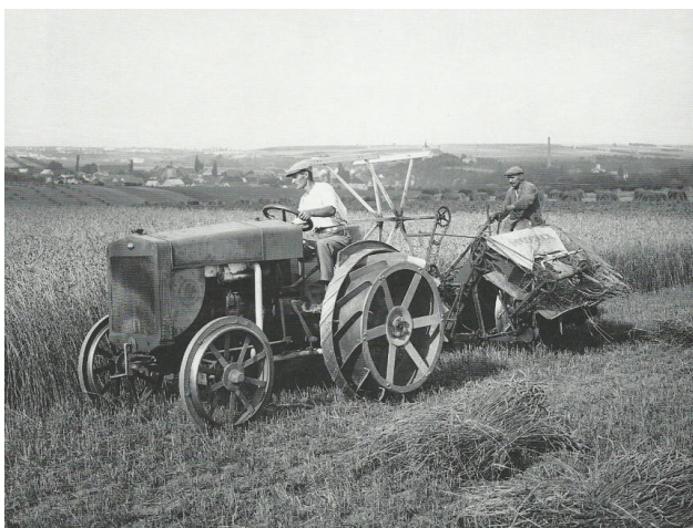
Obrázek 11 Traktor Škoda HT 30 se samovazačem [3]
