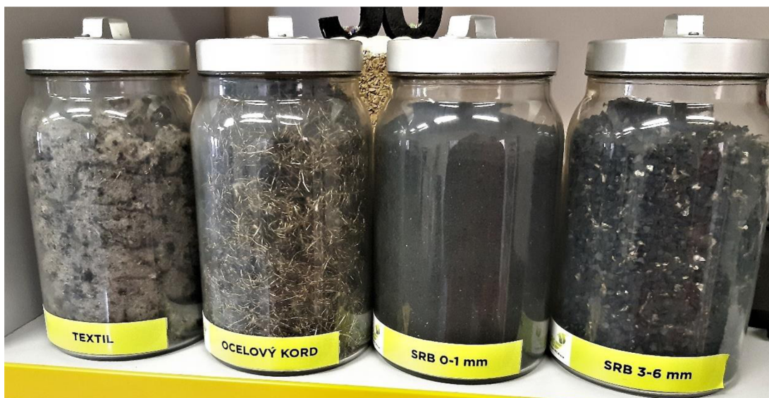
Obrázek 7 Výstupní produkty ze zpracování pneumatik (zleva: textilní vlákno, ocelový kord, prach a granulát)
