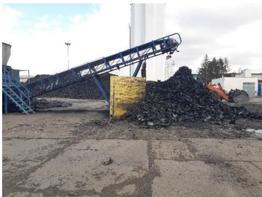
Obrázek 3 Sekání pneumatik na drť
