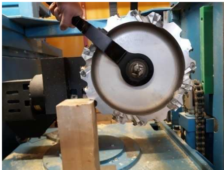
Obr. 51 Výměna válcové frézy
