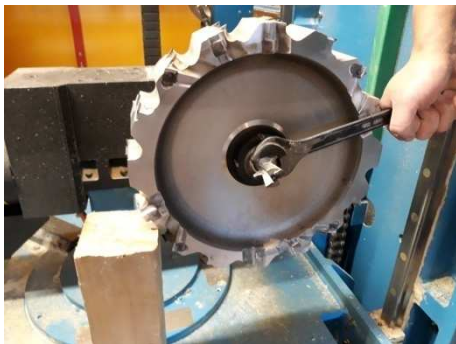
Obr. 53 Výměna rybinové frézy
