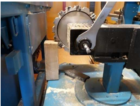
Obr. 52 Výměna čelní stopkové frézy
