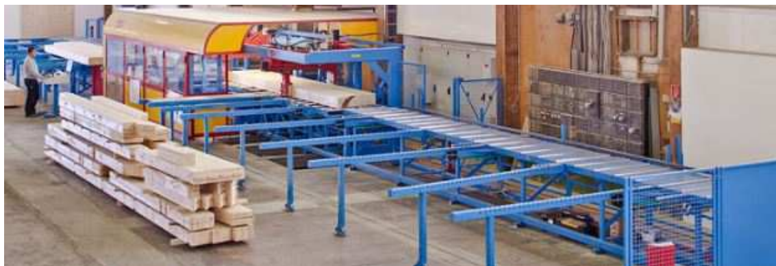
Obr. 27 Obráběcí centrum Hundegger K2i
