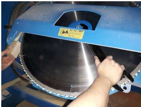
Obr. 50 Výměna pilového kotouče
