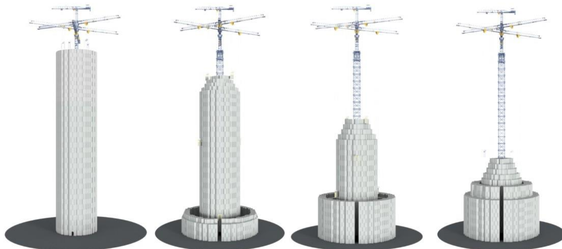
Obrázek 3: Gravitační baterie navržená firmou Vault Energy (vlevo nabitá, vpravo vybitá). Zdroj: New atlas, 2018
