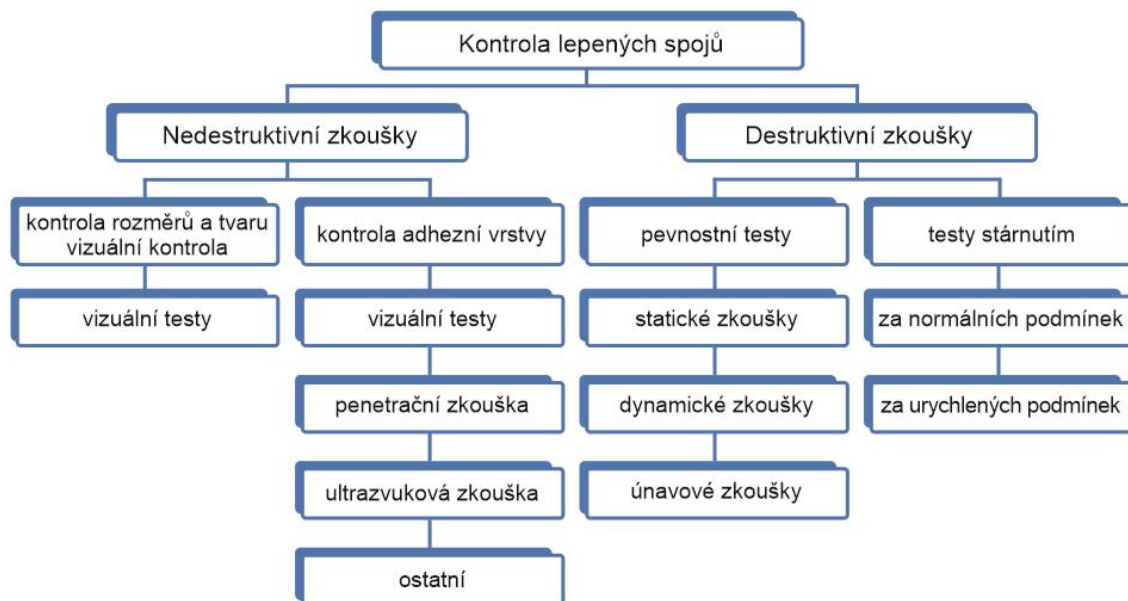
Obr. 14 Rozdělení druhů zkoušek lepených spojů [22].
