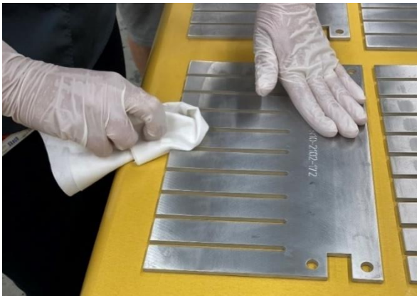
Obr. 30 Čištění hliníkového hřebenu Sika Cleanerem P.
