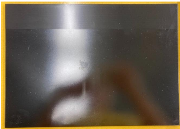
Obr. 32 Sklo s nanesenou vrstvou primeru.
