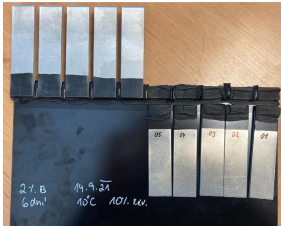
Obr. 39 Vzorky po provedení smykové zkoušky – přetržené vzorky.
