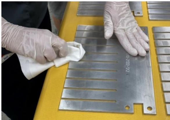
Obr. 30 Čištění hliníkového hřebenu Sika Cleanerem P.
