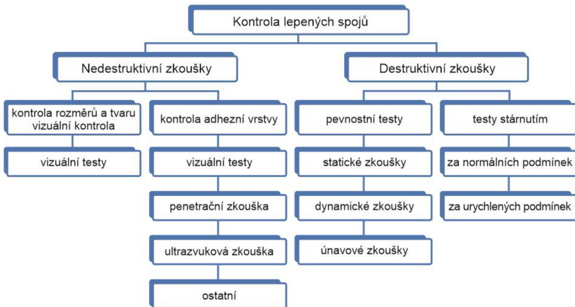
Obr. 14 Rozdělení druhů zkoušek lepených spojů [22].
