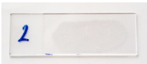
Obrázek 12: Agarózový gel na mikroskopickém sklíčku po vysušení
