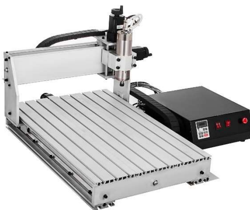
Obrázek 23: Vevor 4axis CNC Router 6040 ( https://eur.vevor.com , 5.3. 2022)
