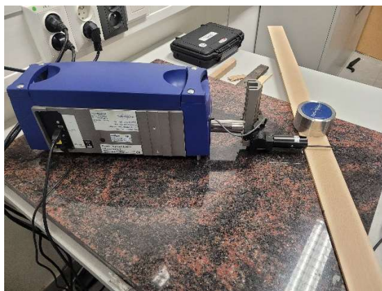
Obrázek 13: Kontaktní profilometr FORM TALYSURF 50 Intra
