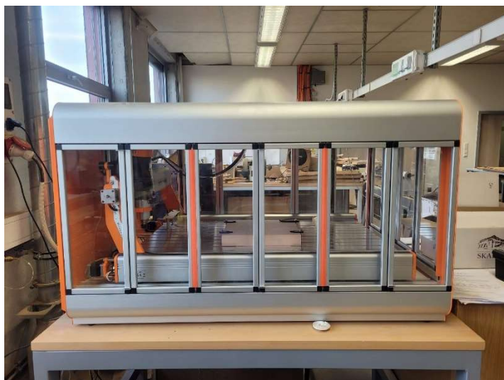
Obrázek 11: Stolní obráběcí centrum – Stepcraft D.840 (foceno z čela)
