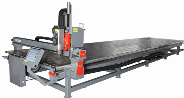
Obrázek 24: CNC centrum – Volter L8020 ( https://volter.com , 5.3. 2022)
