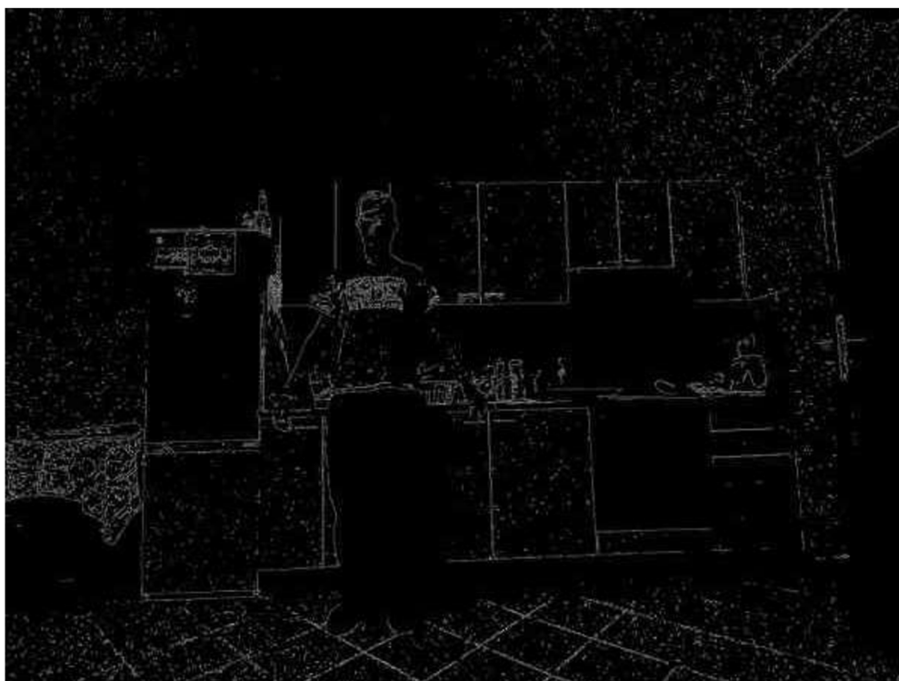
Obr. 6.4: Binárny obraz hrán po detektore Canny()
