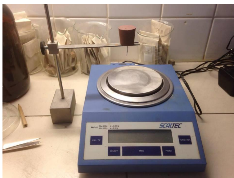
Obr. 4 Laboratorní váha SCALTEC a speciální stojan s jehlou
