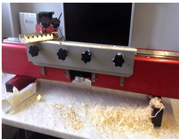
Obr. 5 Seřezávání vývrtů na mikrotomu
