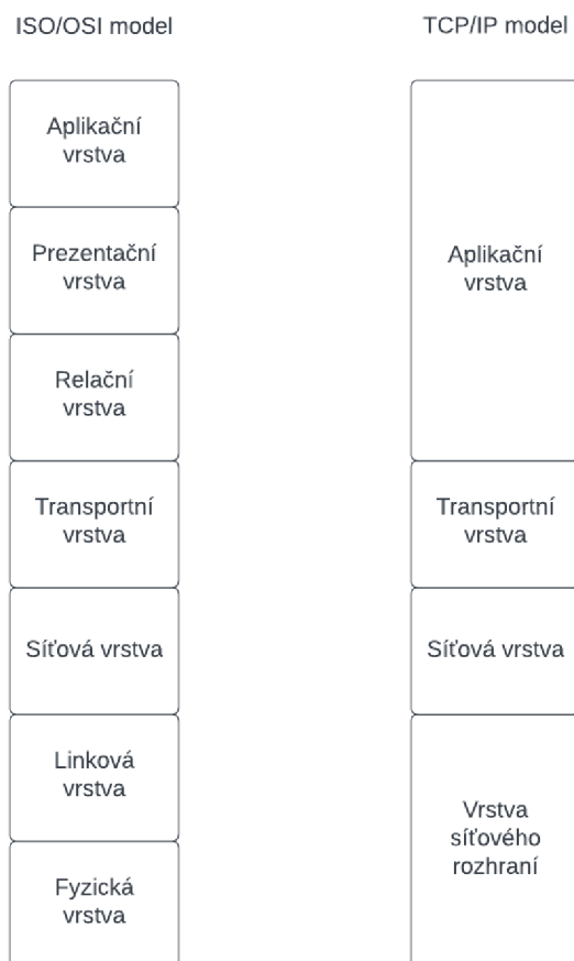
Obrázek 8: Srovnání síťových modelů ISO/OSI a TCP/IP
