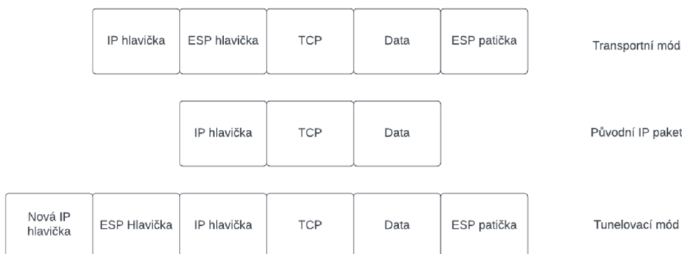
Obrázek 14: IPSec paket - transportní a tunelovací mód
