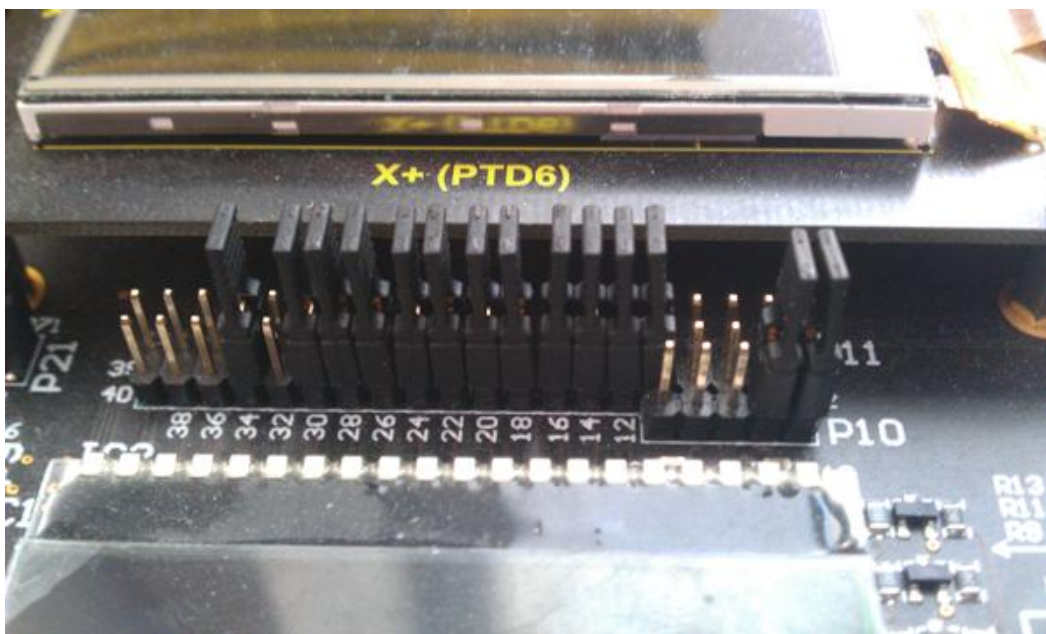
Obrázek 5.1: Propojení pinů na portu P11 a P10
